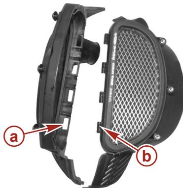
**a** - Verriegelungsöffnung der oberen Schwungradabdeckung
