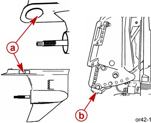
**a** - Opferanoden (Getriebegehäuse)
