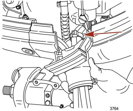
3. Die Schelle mit dem Halter und zwei Schrauben in der Motorwanne befestigen.
