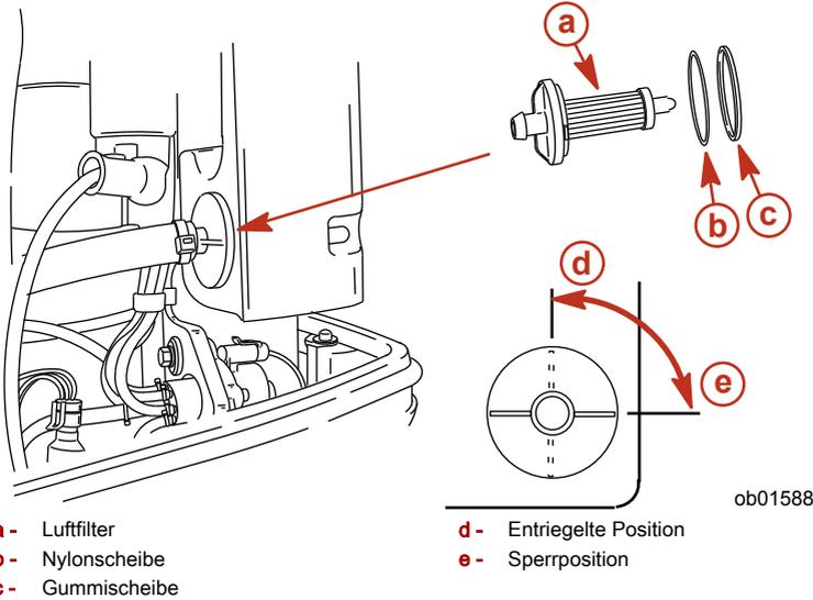
2. Den Filter in die Öffnung einführen. Die vordere Spitze des Filters in die Öffnung setzen. Die zwei Laschen am Filterdeckel mit den Kerben in der Öffnung ausrichten.
