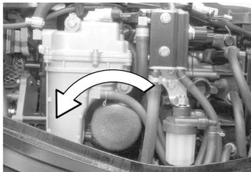
3. Den Montagesockel reinigen. Eine dünne Schicht sauberes Öl auf die Filterdichtung auftragen. Keine Schmiermittel verwenden. Den neuen Filter aufschrauben, bis die Dichtung den Sockel berührt, und anschließend eine Dreiviertel- bis volle Umdrehung anziehen.
