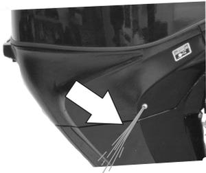
**WICHTIG:** Falls kein Wasser aus der Wasserpumpenkontrolldüse austritt, den Motor abstellen und prüfen, ob die Kühlwasser-Einlassöffnung verstopft ist. Wenn keine Verstopfung vorliegt, kann dies auf eine defekte Wasserpumpe oder eine Verstopfung im Kühlsystem hinweisen. Diese Zustände bewirken eine Überhitzung des Motors. Den Außenborder vom Händler prüfen lassen. Der Betrieb des Motors im überhitzten Zustand führt zur Beschädigung des Motors.
