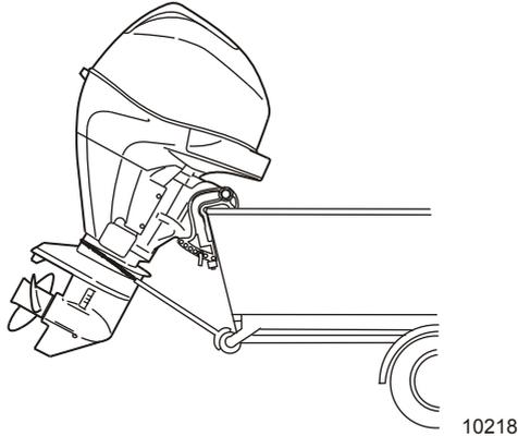
**WICHTIG:** Zur Bewahrung des korrekten Bodenabstandes bei Transport auf einem Anhänger nicht auf das Power-Trimm-/Kippsystem oder den Kippstützhebel verlassen. Der Kippstützhebel des Außenborders ist nicht dazu vorgesehen, den Außenborder für den Anhängertransport zu stützen.
