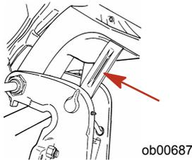
2. Einfülldeckel entfernen und den Flüssigkeitsstand prüfen. Die Flüssigkeit muss bis zur Unterkante der Einfüllöffnung reichen. Power-Trim- und Servolenkflüssigkeit von Quicksilver oder Mercury Precision einfüllen. Wenn diese Flüssigkeit nicht zur Verfügung steht, Automatikgetriebeöl (ATF) verwenden.
