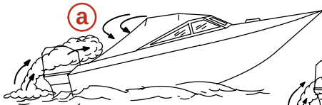
a - Betrieb des Boots mit zu hoch eingestelltem Bugtrimmwinkel.
