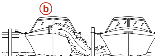
b - Vertäuen direkt neben einem anderen Boot, dessen Motor läuft.
