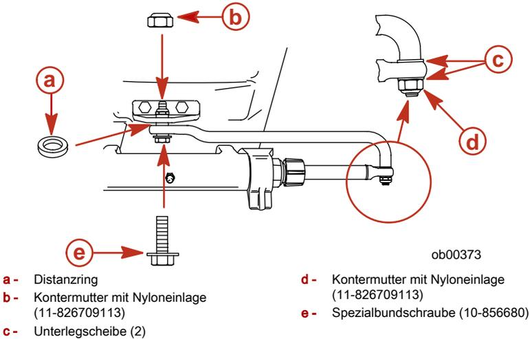
Das Lenkgestänge mit zwei flachen Unterlegscheiben und einer selbstsichernden Mutter mit Nyloneinlage ("b" - Teilenummer 11-34863) an den Lenkzug montieren. Die Sicherungsmutter fest anziehen und dann um eine Viertelumdrehung herausdrehen.
