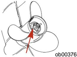
4. Einen Holzblock zwischen Getriebegehäuse und Propeller klemmen, um den Propeller zu fixieren. Die Propellermutter entfernen.
