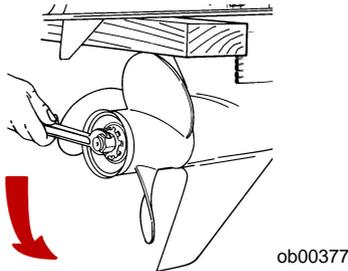
6. Die Propellerwelle mit Quicksilver oder Mercury Precision Lubricants Anti-Corrosion Grease (Korrosionsschutzfett) oder 2-4-C with Teflon (Bootsschmiermittel mit Teflon) schmieren.
