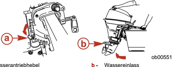
**WICHTIG:** Während der Außenborder in der Flachwasserposition ist, darf er nicht im Rückwärtsgang betrieben werden. Den Außenborder mit niedriger Drehzahl betreiben und darauf achten, dass der Kühlwassereinlass stets unter Wasser liegt.
