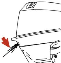
**WICHTIG:** Falls kein Wasser aus der Wasserpumpenkontrolldüse austritt, den Motor abstellen und prüfen, ob die Kühlwasser-Einlassöffnung verstopft ist. Wenn keine Verstopfung vorliegt, kann dies auf eine defekte Wasserpumpe oder eine Verstopfung im Kühlsystem hinweisen. Diese Zustände bewirken eine Überhitzung des Motors. Den Außenborder vom Händler prüfen lassen. Der Betrieb des Motors im überhitzten Zustand führt zu schweren Motorschäden.
