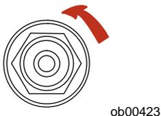
3. Den Elektrodenabstand auf Spezifikation einstellen.
