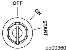
2. **Modelle mit Steuerpinne** - Die Motordrehzahl zurücknehmen und den Leerlauf einlegen. Den Ausschalter des Motors eindrücken oder den Zündschlüssel auf OFF (AUS) stellen.
