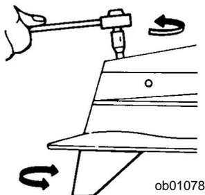
**HINWEIS:** Die Einstellung der Trimmflosse zur Reduzierung des Lenkmoments hat nur wenig Einfluss, wenn der Außenborder so installiert ist, dass die Antiventilationsplatte sich ca. 50 mm (2 in.) oder mehr über dem Bootsboden befindet.
