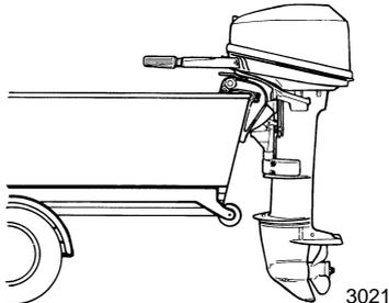
**WICHTIG: Die Kipp Sperre und Flachwasserfunktion (Modelle mit Ruderpinne) des Außenborders sind nicht dazu geeignet, den Außenborder in der angekippten Position abzustützen.**
