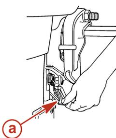
a - Hebel für Flachwasserantrieb
