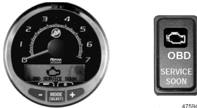
SC 1000 Anzeige und Motorstörungsleuchte
