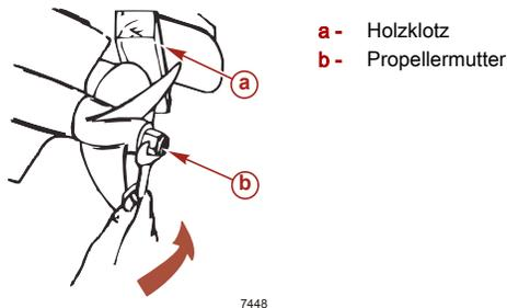
2. Die Muttern und die Unterlegscheibe entfernen.
