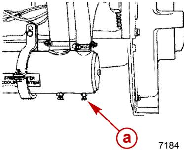
a - Hintere Wärmetauscher-Ablassschraube
