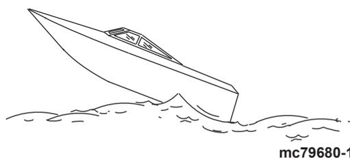
Die Fahrt über Wellen und Kielwasser gehört zum Bootsfahren. Wenn dies jedoch mit so hoher Geschwindigkeit getan wird, dass der Rumpf teilweise oder ganz aus dem Wasser springt, entstehen bestimmte Risiken, besonders beim Wiedereintritt des Boots ins Wasser.
