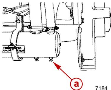
a - Wärmetauscher-Ablasstopfen
