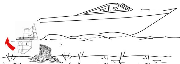
**WICHTIG:** Um das Risiko von Verletzungen oder Schäden durch Aufprall auf Treibgut oder ein unter Wasser liegendes Hindernis so weit wie möglich zu reduzieren, muss die Bootsgeschwindigkeit reduziert werden. Unter diesen Bedingungen sollte das Boot mit einer Geschwindigkeit von maximal 24–40 km/h (15–25 mph) betrieben werden.
