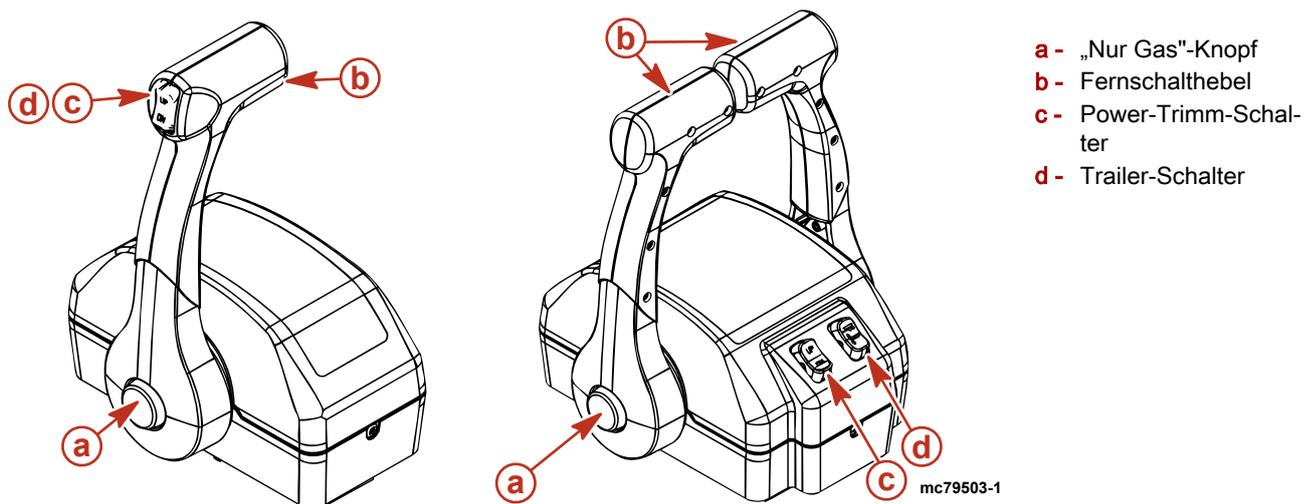
**„Nur Gas“-Taste** – Ermöglicht das Vorschieben des Gashebels ohne Einlegen des Ganges. Hierzu wird der Schaltmechanismus vom Fernschalthebel getrennt. Der Nur-Gas-Knopf kann nur gedrückt werden, wenn die Fernschaltung auf Neutral steht.
