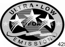
42538  | Die Plakette mit drei Sternen kennzeichnen Motoren, die die Emissionsnormen des Air Resources Board für Kleinboote und Außenborder für das Jahr 2008 oder die Emissionsnormen für Z-Antriebe und Innenborder für das Jahr 2003 erfüllen. Die Abgaswerte von Motoren, die diese Normen erfüllen, sind 65 % niedriger als die von Motoren mit einem Stern (Niedrige Emission).                                                                                     |
