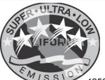
42539 | Die Plakette mit vier Sternen kennzeichnet Motoren, die die Emissionsnormen des Air Resources Board für Z-Antriebe und Innenborder für das Jahr 2009 erfüllen. Kleinboote und Außenborder erfüllen diese Normen ggf. auch. Die Abgaswerte von Motoren, die diese Norm erfüllen, sind um 90 % niedriger als die von Motoren mit einem Stern (Niedrige Emission).                                                                                                  |
