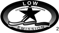
22531  | Die Plakette mit einem Stern kennzeichnet Kleinboote, Außenborder, Z-Antriebe und Innenborder, die die Emissionsnormen des Air Resources Board für Kleinboote und Außenborder für das Jahr 2001 erfüllen. Die Abgaswerte von Motoren, die diese Norm erfüllen, sind um 75% niedriger als die Werte herkömmlicher Zweitakt-Vergasermotoren. Diese Motoren entsprechen den Normen für Bootsmotoren der amerikanischen Umweltschutzbehörde (EPA) für das Jahr 2006. |
