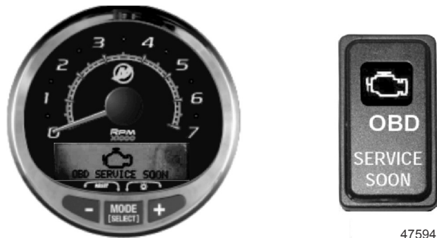
SC 1000 Anzeige und Motorstörungsleuchte
