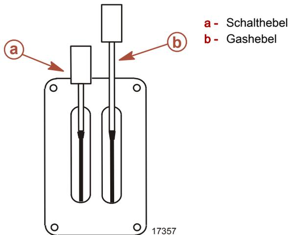
**Schalthebel** - Die Schaltfunktionen werden durch den Schalthebel gesteuert. Den Hebel nach hinten ziehen, um in den Rückwärtsgang zu schalten. Den Schalthebel in die mittlere Stellung bewegen, um das Getriebe auf Neutral zu schalten. Den Hebel nach vorne schieben, um den Vorwärtsgang einzulegen.
