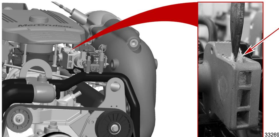
Leerlaufsteuerungsventil-Schalldämpfer im Leerlaufsteuerungsventil-Adapter installiert
