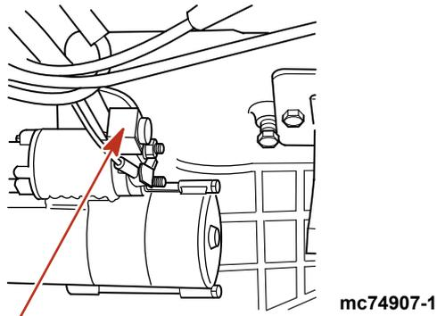
Vier Sicherungen an der Backbordseite des Motors schützen die Hauptstromversorgungs-, Kraftstoffpumpen-, Zündungs- und Zubehörkreise.
