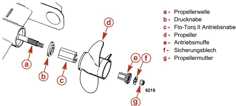
1. Eine dicke Schicht eines der folgenden Schmiermittel auf die Propellerwelle auftragen.
