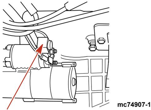
**Sicherung des Motorkabelbaums**
