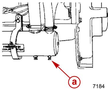
a - Wärmetauscher-Ablassstopfen
