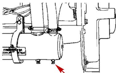
a - Hintere Wärmetauscher-Ablassschraube
