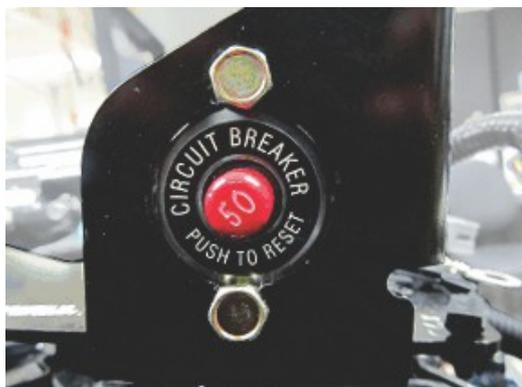
Motorkabelbaum und Sicherungsautomat der Instrumente
