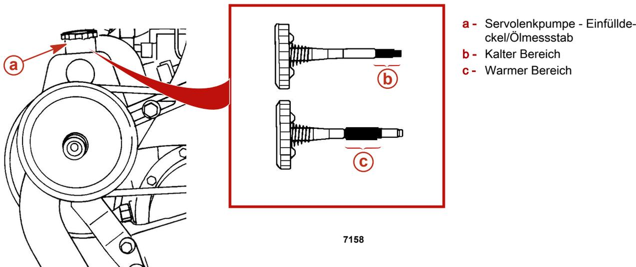
3. Bis zur FULL Markierung mit korrektem Öl füllen.
