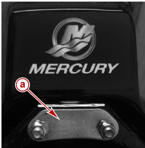
**Bügelschraubenplatte der Bravo Spiegelplatte**
