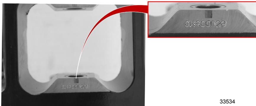
Eingepreßte Seriennummer an Bravo Z-Antrieben
