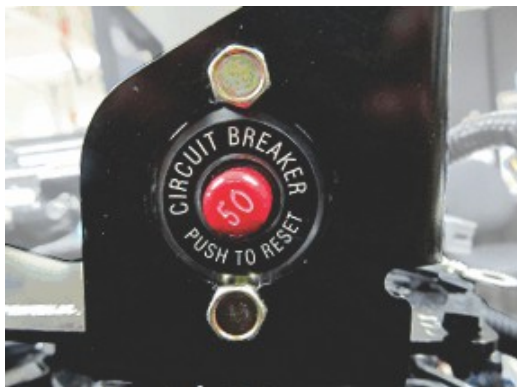
Motorkabelbaum und Sicherungsautomat der Instrumente
