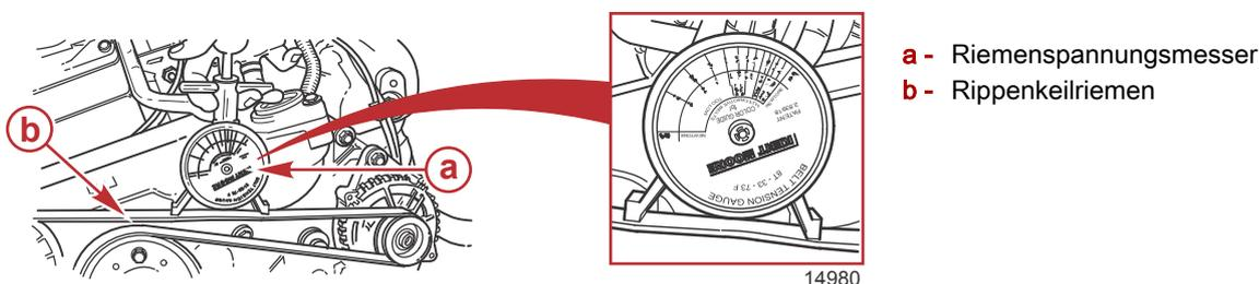
7. Die Stellschraube bei der korrekten Riemen Spannung halten und die 16 mm (5/8 in.) Kontermutter festziehen.
