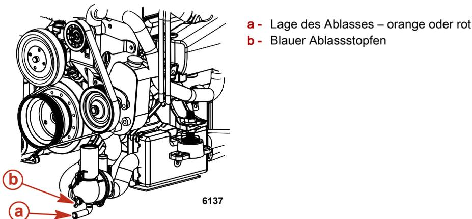
4. Das System mindestens 5 Minuten lang ablaufen lassen. Wir empfehlen, die Ablasstopfen während des Bootstransports oder bei Durchführung anderer Wartungsarbeiten ausgebaut zu lassen, um sicherzustellen, dass alles Wasser ausgelaufen ist.
