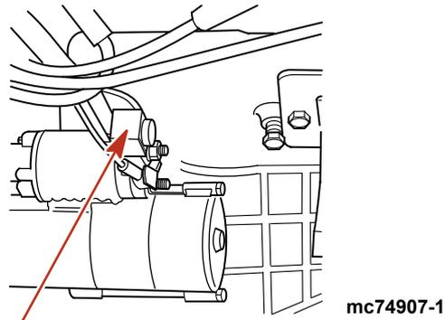
Vier Sicherungen an der Backbordseite des Motors schützen die Hauptstromversorgungs-, Kraftstoffpumpen-, Zündung- und Zubehörkreise.
