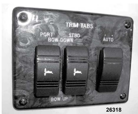
Typische Trimmflossenschalter (automatisch und manuell).
