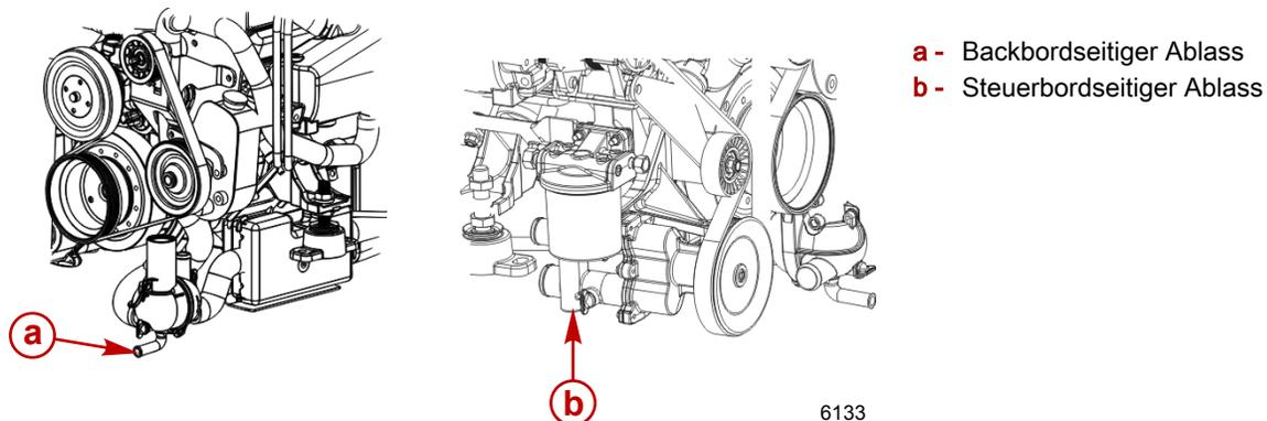
9. Das System mindestens 5 Minuten lang ablaufen lassen. Bei Bedarf Luft in das System pumpen, damit die grünen Anzeiger ausgefahren bleiben.
