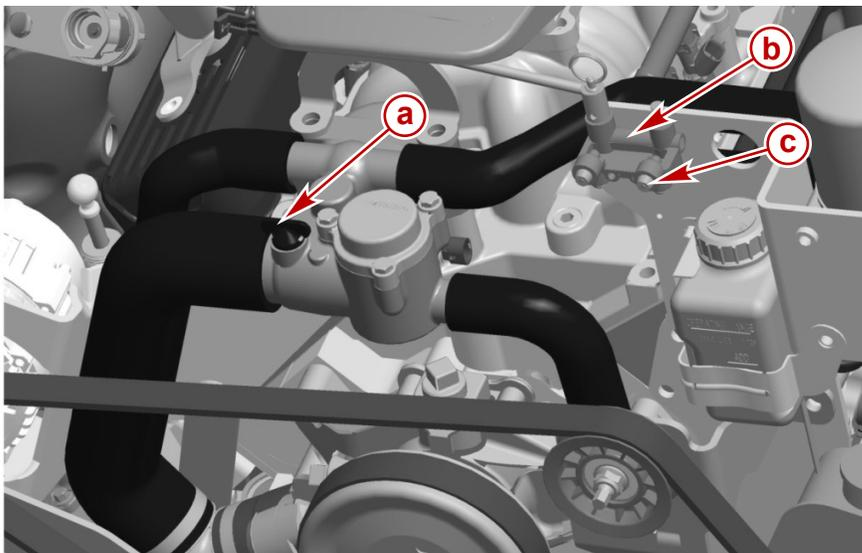
8. Sicherstellen, dass aus allen Öffnungen Wasser fließt. Andernfalls die Anweisungen unter **Manuelles Dreipunkt-Ablasssystem** befolgen.
