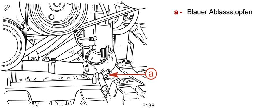
3. Zur ordnungsgemäßen Entlüftung des Kühlsystems den blauen Ablassstopfen innerhalb von 30 Sekunden aus der Seite des Thermostatgehäuses entfernen.
