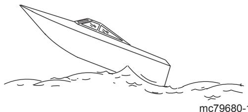
Die Fahrt über Wellen und Kielwasser gehört zum Bootsfahren. Wenn dies jedoch mit so hoher Geschwindigkeit erfolgt, dass der Rumpf teilweise oder ganz aus dem Wasser springt, entstehen bestimmte Risiken, besonders beim Wiedereintritt des Boots ins Wasser.
