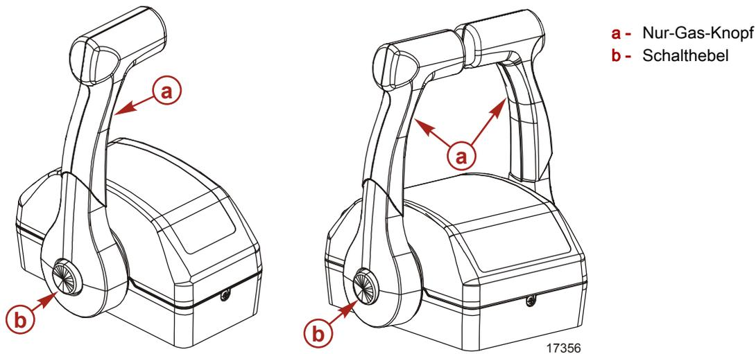
**Nur-Gas-Knopf** – Ermöglicht das Verschieben des Gashebels ohne Einlegen des Ganges. Hierzu wird der Schaltmechanismus vom Fernschalthebel getrennt. Der Nur-Gas-Knopf kann nur gedrückt werden, wenn die Fernschaltung auf Neutral steht.
