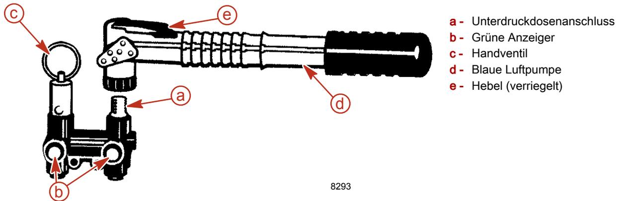
6. Luft in das System pumpen, bis beide grünen Anzeiger ausfahren und Wasser aus beiden Seiten des Motors läuft. Das Wasser tritt zuerst auf der Backbordseite aus.
