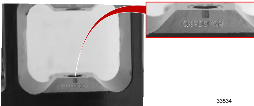
Eingeprägte Seriennummer an Bravo Z-Antrieben
