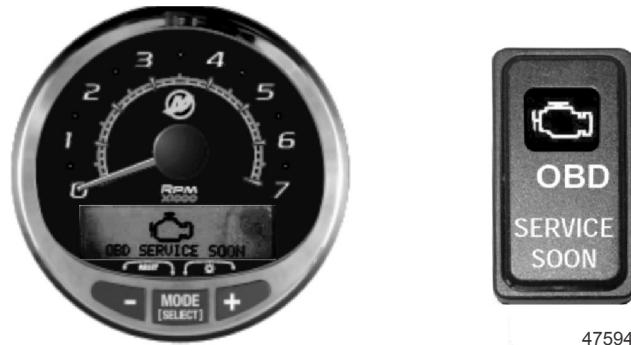
SC 1000 Anzeige und Motorstörungsleuchte
