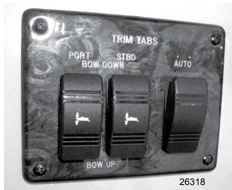
Typische Trimmflossenschalter (automatisch und manuell)
