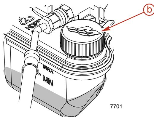
**Flüssigkeitsstand im Power-Trim-Pumpenflüssigkeitsbehälter liegt unter der „MIN“ Markierung**
