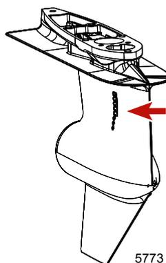
**Seitlicher Wassereinlass am Alpha Z-Antrieb**
