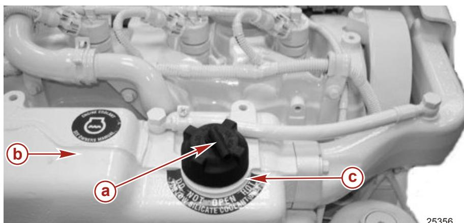
**Motorkühlmittel-Einflüllpunkt (Motorabdeckung entfernt)**
