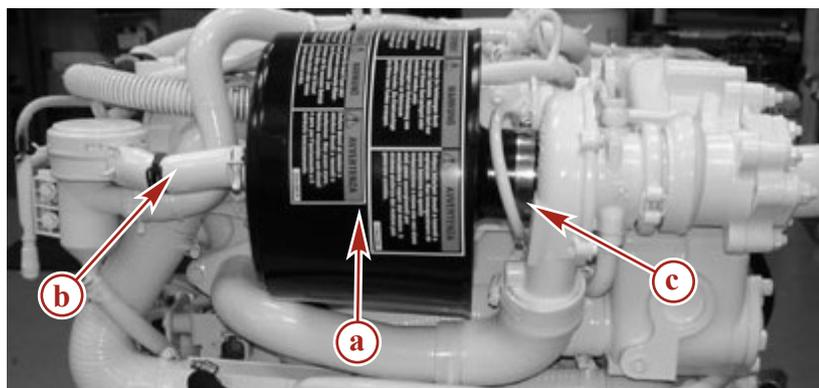
**Luftfiltergehäuse am Motor installiert**
