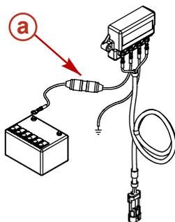
**a - 20-A-Sicherung im Kabel**
