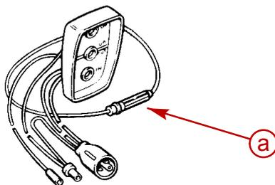
**a - 20-A-Sicherung im Kabel**
