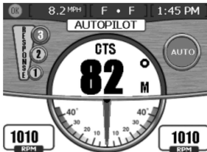
4. Die Standard-Kurseinstellungen können angepasst werden, wenn die Funktion Auto-Kurs aktiviert ist und die Leuchte in der Taste aufleuchtet. Hierzu die entsprechende „Turn“-Taste (Drehen) am Touchpad drücken oder den Joystick (schnell) antippen.
