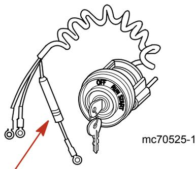
Der an der Starterbatterie des Motors angeschlossene Stromkabelbaum minimiert den Spannungsabfall zur Elektrik und ist durch eine 5-A-Sicherung geschützt.
