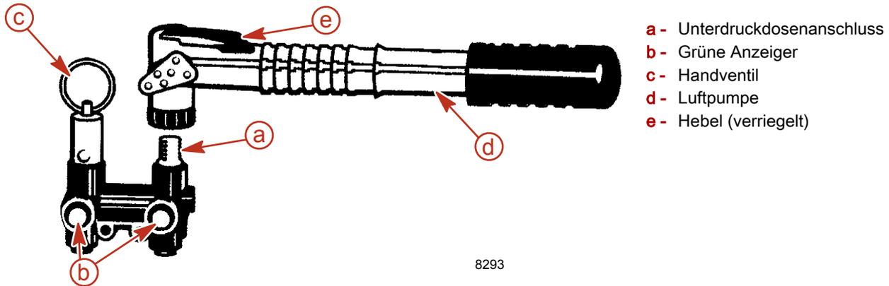
6. Luft in das System pumpen, bis beide grünen Anzeiger ausfahren und Wasser aus beiden Seiten des Motors läuft. Die Backbordseite entleert sich vor der Steuerbordseite.
