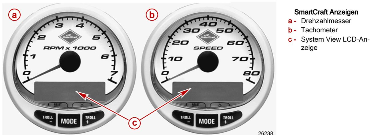
Das SmartCraft Instrumentenpaket hilft ebenfalls bei der Motorschutzsystem-Diagnose. Das SmartCraft Instrumentenpaket zeigt kritische Motoralarmdaten und potenzielle Probleme an.
