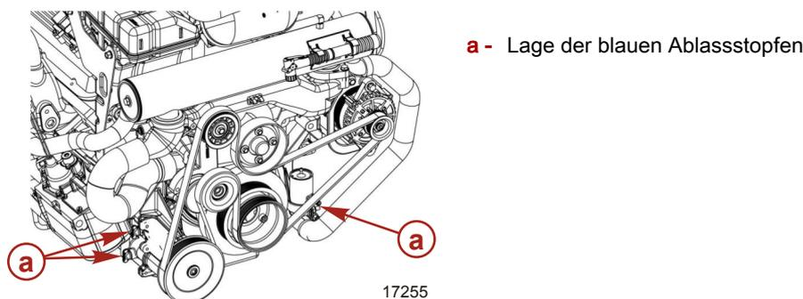
3. Sicherstellen, dass das Wasser aus allen Öffnungen ausläuft.
