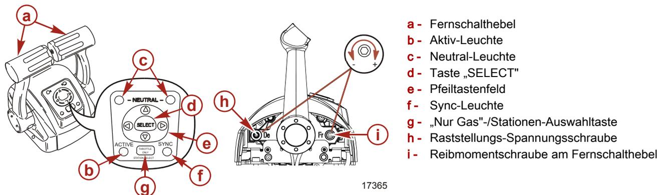
**Fernschaltgriff** –Bedienung von Gas und Schaltung wird durch den Fernschaltgriff gesteuert. Den Schalthebel aus Neutral zügig nach vorne in die erste Einrastposition schieben, um den Vorwärtsgang einzulegen. Den Hebel weiter vorschieben, um die Drehzahl zu erhöhen. Den Schalthebel aus Neutral zügig nach hinten in die erste Einrastposition ziehen, um den Rückwärtsgang einzulegen, und weiter nach hinten ziehen, um die Drehzahl zu erhöhen.
