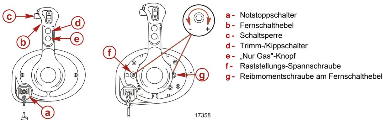
**Notstoppschalter mit Reißleine** - Schaltet die Zündung aus, wenn sich der (mit der Reißleine verbundene) Bootsführer weit genug von seiner Position entfernt, um den Schalter auszulösen. Siehe **Notstoppschalter mit Reißleine** bzgl. Informationen über die Verwendung dieses Schalters.
