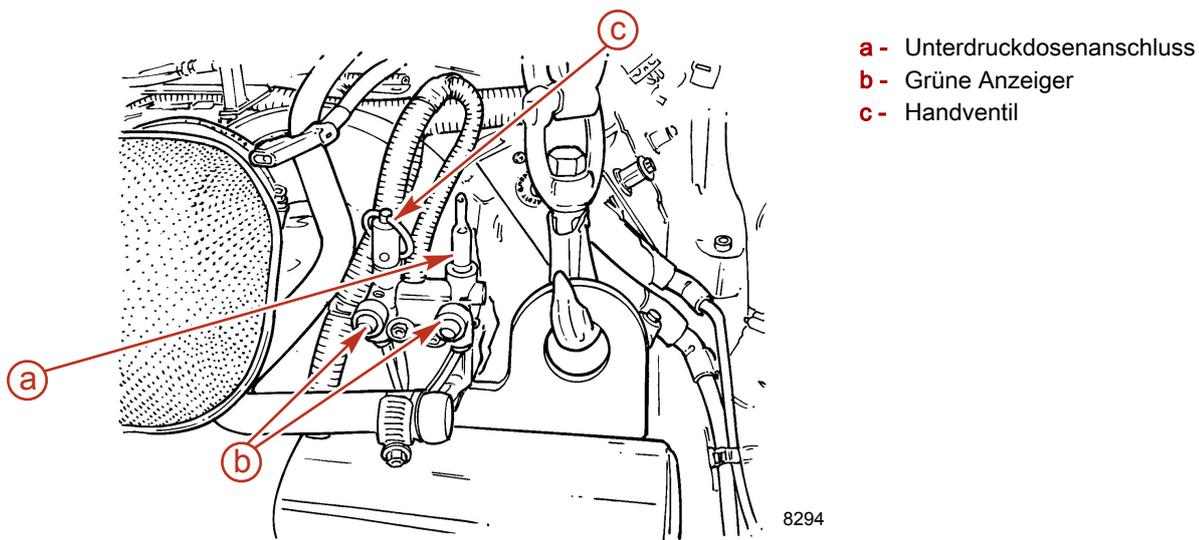
7. Sicherstellen, dass das Wasser aus allen Öffnungen ausläuft. Andernfalls die Anweisungen unter **Manuelles Ablasssystem** befolgen.
