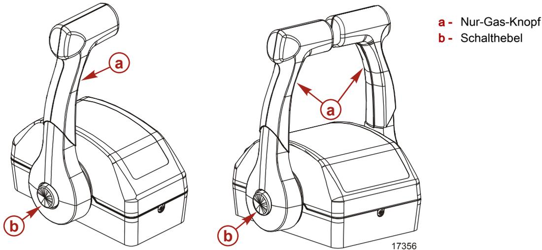
**Nur-Gas-Knopf** – Ermöglicht das Vorschieben des Gashebels ohne Einlegen des Ganges. Hierzu wird der Schaltmechanismus vom Fernschalthebel getrennt. Der Nur-Gas-Knopf kann nur gedrückt werden, wenn die Fernschaltung auf Neutral steht.
