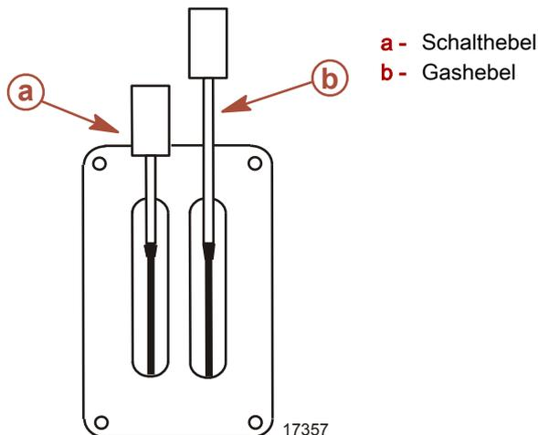
**Schalthebel** – Die Schaltfunktionen werden durch den Schalthebel gesteuert. Den Hebel in die Rückwärts-Position ziehen, um in den Rückwärtsgang zu schalten. Den Schalthebel in die mittlere Stellung bewegen, um das Getriebe auf Neutral zu schalten. Den Hebel nach vorne schieben, um den Vorwärtsgang einzulegen.
