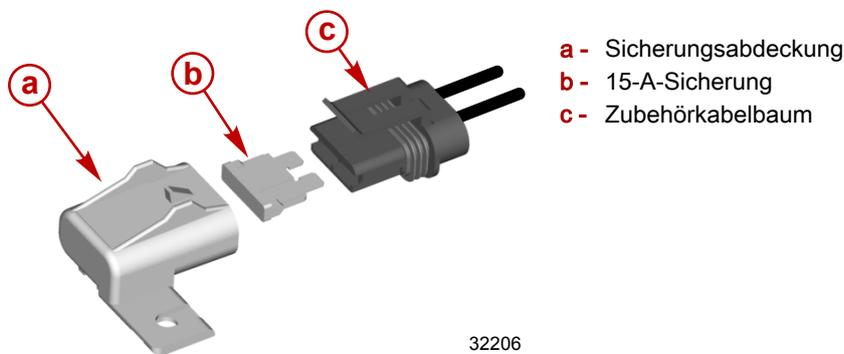
Im „I“ Anschlusskabel befindet sich eventuell eine 20-A-Sicherung, die die Elektrik schützt. Wenn Sie den Zündschlüssel auf START drehen und nichts passiert (und der Sicherungsautomat nicht ausgelöst wurde), muss auf eine durchgebrannte Sicherung geprüft werden.
