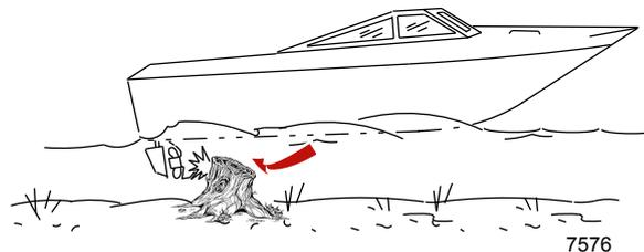
**WICHTIG: Um das Risiko von Verletzungen oder Schäden durch Aufprall auf Treibgut oder ein unter Wasser liegendes Hindernis so weit wie möglich zu reduzieren, muss die Bootsgeschwindigkeit reduziert werden. Unter diesen Bedingungen sollte das Boot mit einer Geschwindigkeit von maximal 24 bis 40 km/h (15 bis 25 MPH) betrieben werden.**
