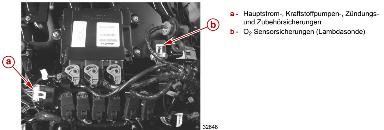
Eine 15-A-Zubehörsicherung schützt die Zubehörkreise. Diese Sicherung befindet sich an der Rückseite des Motors.
