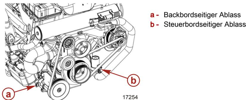
8. Das System mindestens 5 Minuten lang entleeren. Bei Bedarf Luft einpumpen, damit die grünen Anzeiger ausgefahren bleiben.
