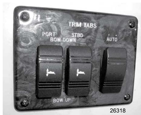
Typische Trimmflossenschalter (automatisch und manuell).
