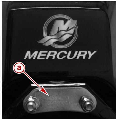
Bügel-schraubenplatte der Bravo Spiegelplatte
