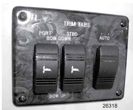
Typische Trimmflossenschalter (automatisch und manuell).
