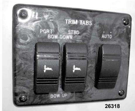
**Typische Trimmflossenschalter mit automatischer Übersteuerung**
