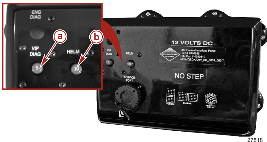
Sicherungsautomaten des Vessel Integration Panel (VIP)
