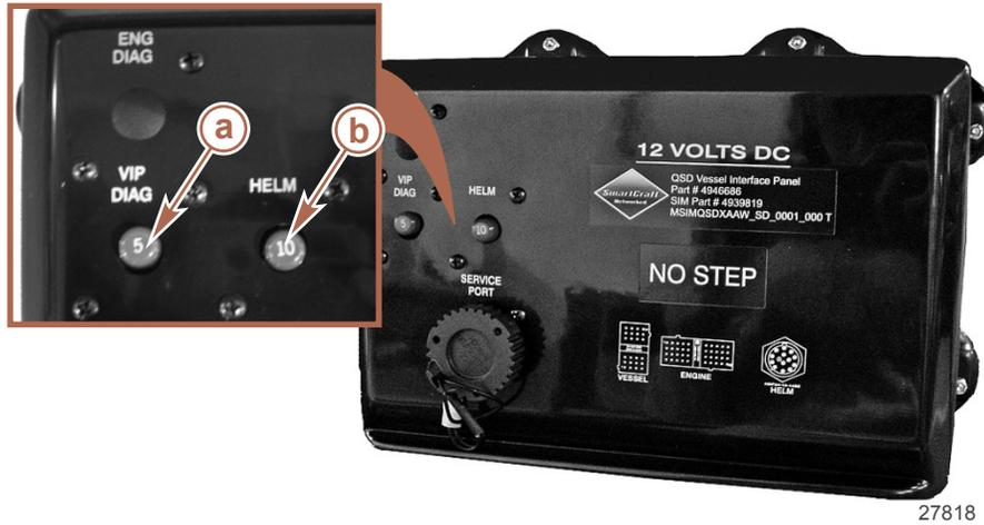
Sicherungsautomaten des Vessel Integration Panel (VIP)
