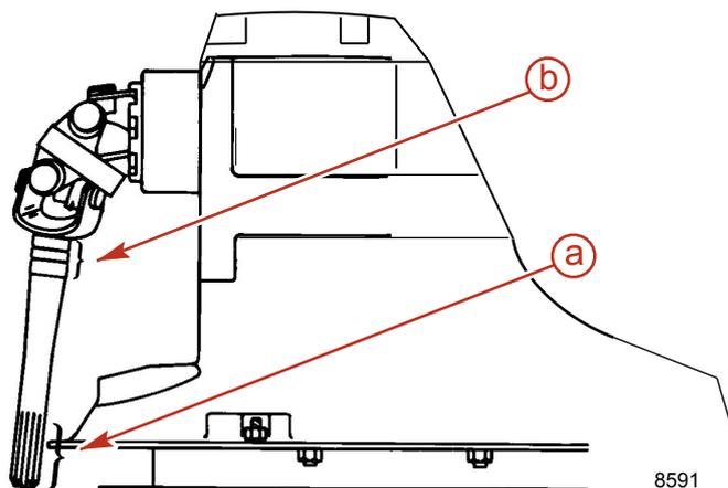
a - Keilwellenprofil der Antriebswelle      b - Gelenkwellen-O-Ringe (3)
