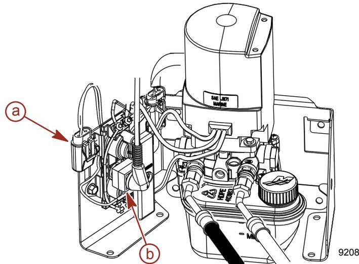
a - 20-A-Flachstecksicherung
