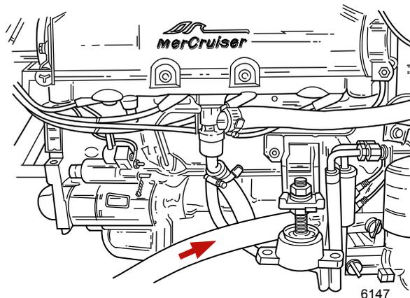
6. Den Spülschlauch mit einem geeigneten Adapter zwischen Wasserhahn und Wassereinlass der Seewasserpumpe anschließen.
