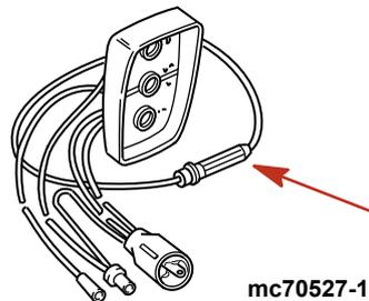
7. Das Quicksilver MerCathode System hat eine 20-A-Sicherung in dem Kabel, das an die Plusklemme (+) der Steuerung angeschlossen ist. Wenn die Sicherung durchgebrannt ist, läuft das System nicht und verliert so den Korrosionsschutz.
