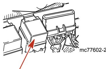
5. Im Zündschalter-Anschlusskabel „I“ befindet sich ggf. eine 20-A-Sicherung zum Schutz der Elektrik. Wenn der Zündschlüssel auf START gedreht wurde und nichts passiert (und der Sicherungsautomat nicht ausgelöst wurde), auf eine durchgebrannte Sicherung prüfen.
