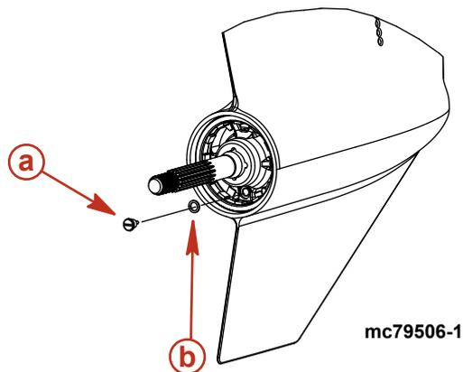
**a** - Öleinfüll-/ablassschraube      **b** - Dichtungsscheibe
