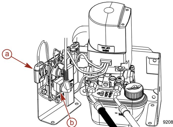
**a** - 20-A-Flachstecksicherung      **b** - 110-A-Sicherung
