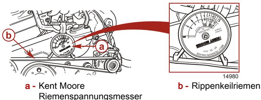
8. Die Stellschraube bei der korrekten Riemenspannung fixieren und die 16 mm (5/8 in.) Kontermutter festziehen.
