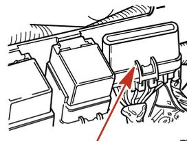
4. Die Hauptstrom- und Kraftstoffpumpenrelais befinden sich neben den Sicherungen. Sie regeln die dem Motor zugeführte Spannung, wenn der Zündschlüssel auf ON (EIN) steht.
