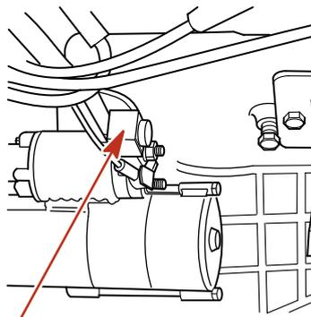
3. Auf der Backbordseite des Motors befinden sich drei Sicherungen. Diese Sicherungen schützen verschiedene Schaltkreise der elektronischen Kraftstoffeinspritzung.
