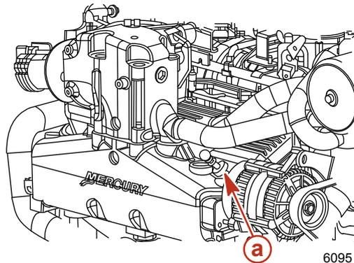
**a** - Peilstab-Führungsrohr
