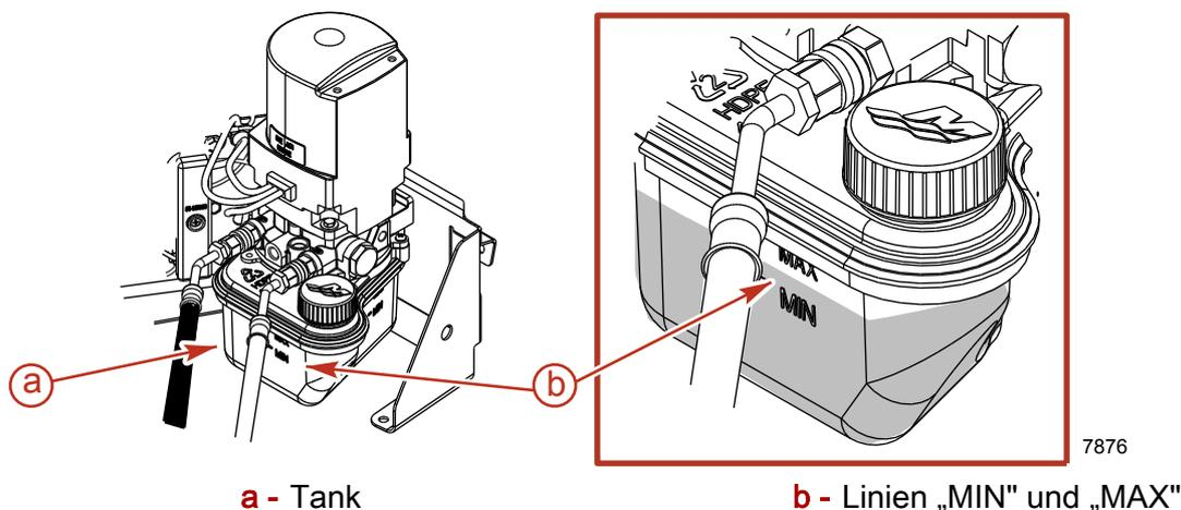
3. Bei Bedarf mit dem angegebenen Öl befüllen.
