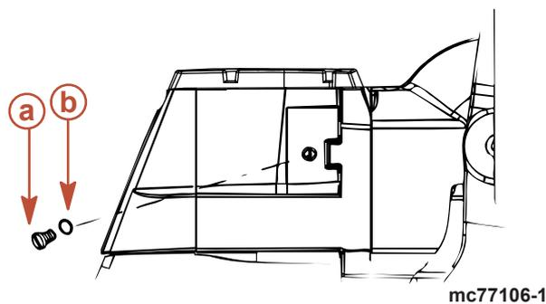
**a** - Entlüftungsschraube      **b** - Dichtungsscheibe
