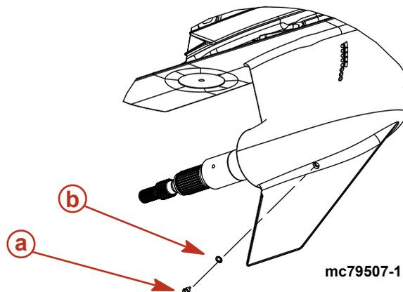
**a** - Öleinfüll-/ablassschraube      **b** - Dichtungsscheibe
