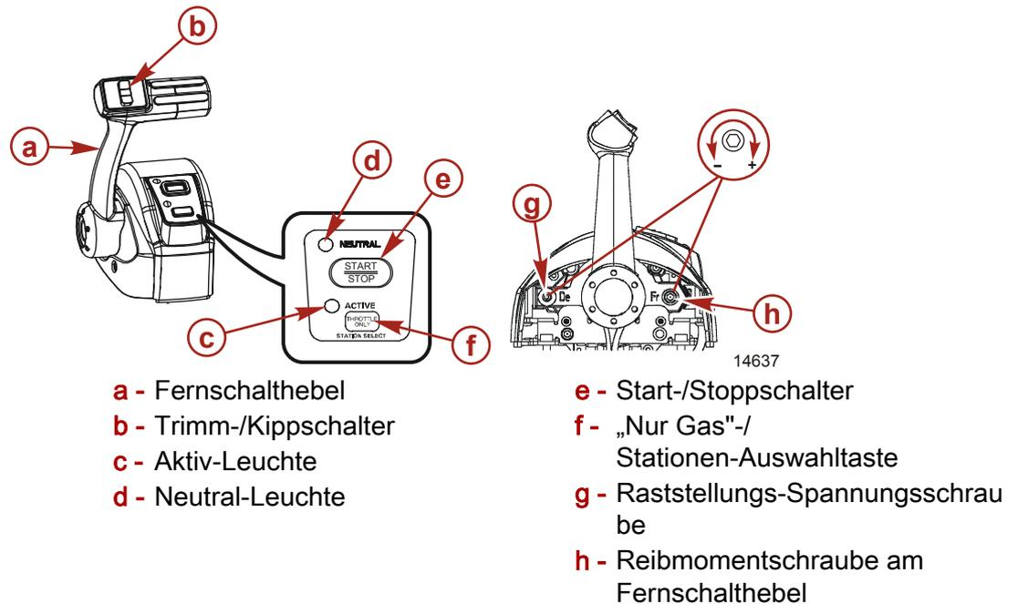
**Fernschaltgriff** –Bedienung von Gas und Schaltung wird durch den Fernschaltgriff gesteuert. Den Schalthebel aus Neutral zügig nach vorne in die erste Einrastposition schieben, um den Vorwärtsgang einzulegen. Den Hebel weiter vorschieben, um die Drehzahl zu erhöhen. Den Schalthebel aus Neutral zügig nach hinten in die erste Einrastposition ziehen, um den Rückwärtsgang einzulegen, und weiter nach hinten ziehen, um die Drehzahl zu erhöhen.
