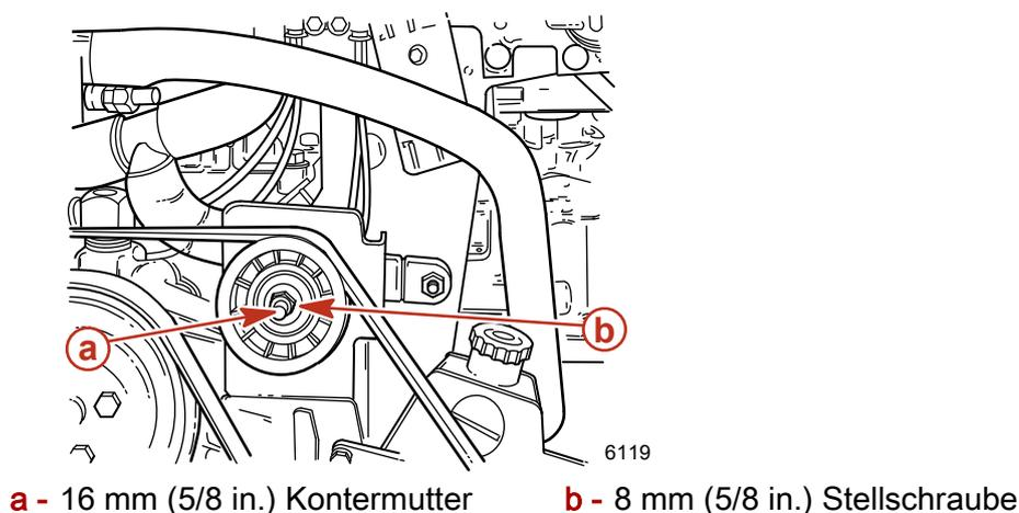
9. Motor kurzzeitig laufen lassen und die Riemenspannung erneut prüfen.
