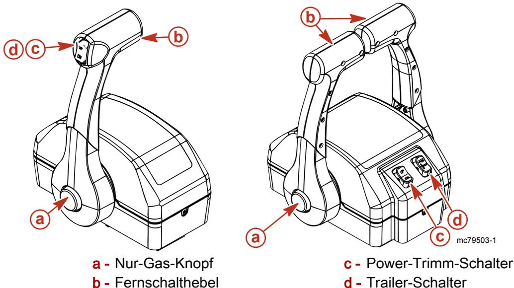
**Nur-Gas-Knopf** - Ermöglicht das Vorschieben des Gashebels ohne Einlegen des Ganges. Hierzu wird der Schaltmechanismus vom Fernschalthebel getrennt. Der Nur-Gas-Knopf kann nur gedrückt werden, wenn die Fernschaltung auf Neutral steht.
