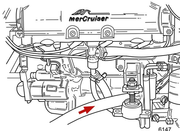
7. Den Spülschlauch mit einem geeigneten Adapter zwischen Wasserhahn und Wassereinlass der Seewasserpumpe anschließen.
