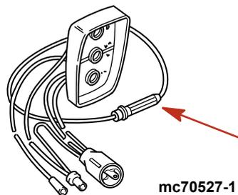
8. Das Quicksilver MerCathode System hat eine 20-A-Sicherung in dem Kabel, das an die Plusklemme (+) der Steuerung angeschlossen ist. Wenn die Sicherung durchgebrannt ist, funktioniert das System nicht und verliert so den Korrosionsschutz.
