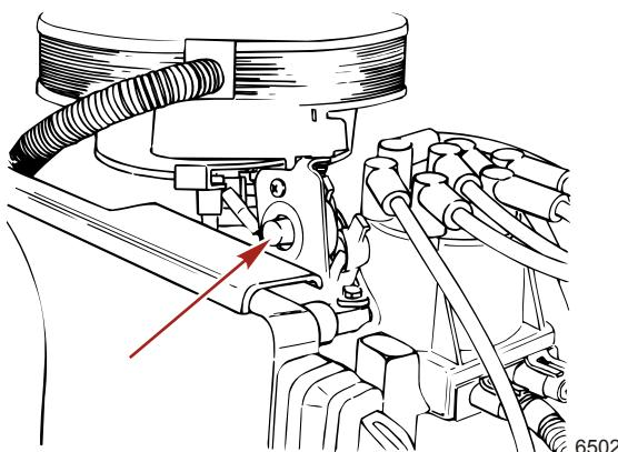
2. Am großen Pol des Einrückrelais befindet sich eine 90-A-Sicherung. Diese Sicherung schützt den Motorkabelbaum im Falle einer elektrischen Überlastung.
