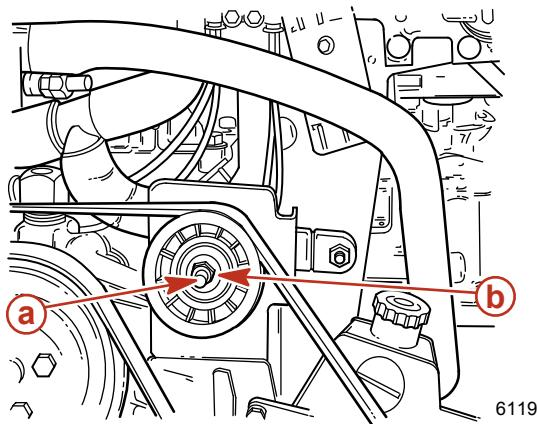
**a** - 16 mm (5/8 in.) Kontermutter      **b** - 8 mm (5/8 in.) Stellschraube
