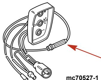
6. Eine 20-A-Sicherung befindet sich neben dem TKS-Modul am Vergaser. Diese Sicherung schützt die Verkabelung des TKS-Moduls im Falle einer elektrischen Überlastung.
