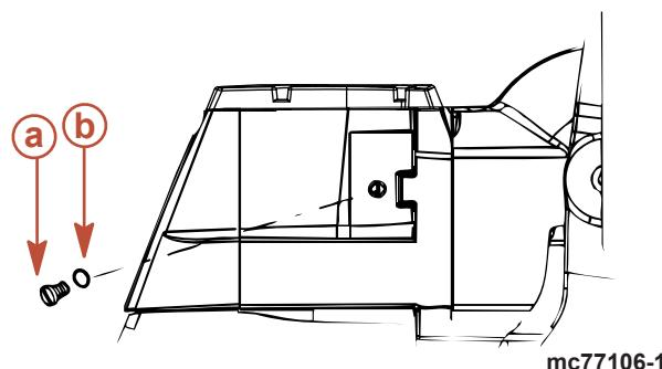
a - Entlüftungsschraube      b - Dichtungsscheibe
