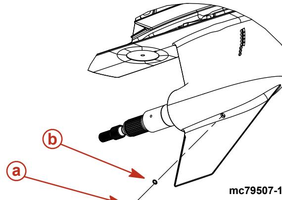
a - Öleinfüll-/ablassschraube      b - Dichtungsscheibe
