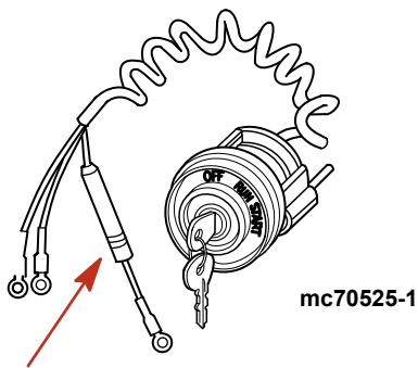
4. Das Power-Trimm-System ist durch eine 110-A-Sicherung und eine 20-A-Stecksicherung an der Power-Trimm-Pumpe vor Überlastung geschützt.
