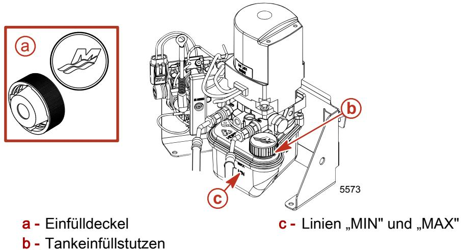
3. Ölstand prüfen. Der Ölstand muss zwischen den Linien „MIN“ und „MAX“ am Öltank stehen.
