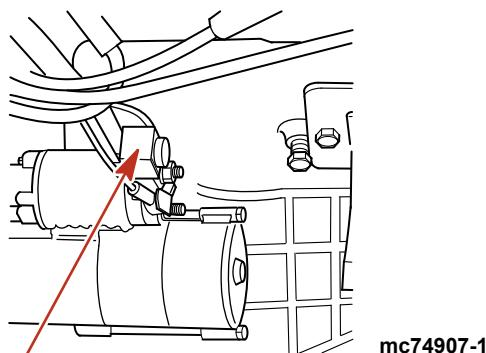
3. Im Zündschalter-Anschlusskabel „I“ befindet sich ggf. eine 20-A-Sicherung zum Schutz der Elektrik. Wenn der Zündschlüssel auf START gedreht wurde und nichts passiert (und der Sicherungsautomat nicht ausgelöst wurde), auf eine durchgebrannte Sicherung prüfen.
