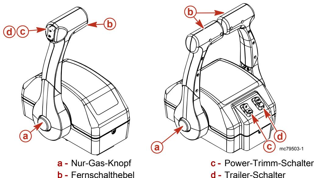
**Nur-Gas-Knopf** - Ermöglicht das Vorschieben des Gashebels ohne Einlegen des Ganges. Hierzu wird der Schaltmechanismus vom Fernschalthebel getrennt. Der Nur-Gas-Knopf kann nur gedrückt werden, wenn die Fernschaltung auf Neutral steht.
