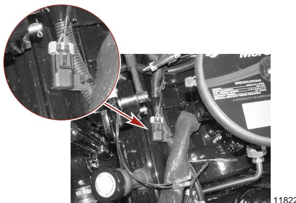
7. Das Quicksilver MerCathode System hat eine 20-A-Sicherung in dem Kabel, das an die Plusklemme (+) der Steuerung angeschlossen ist. Wenn die Sicherung durchgebrannt ist, läuft das System nicht und bietet keinen Korrosionsschutz.
