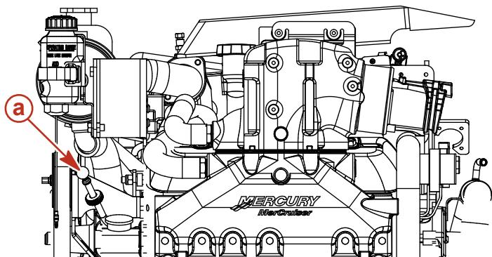
**a - Peilstab-Führungsrohr**
