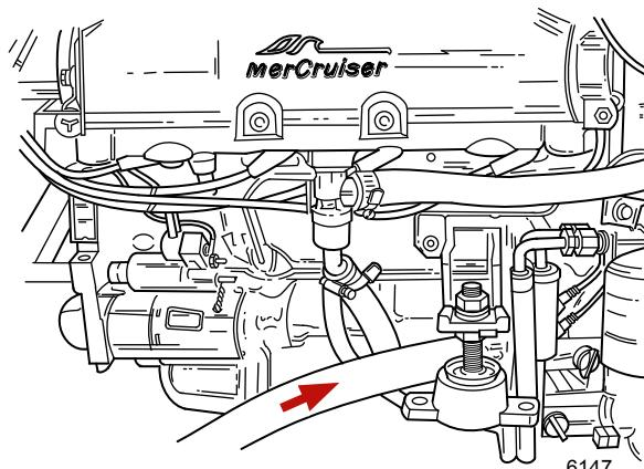
7. Den Spülzulaufschlauch mit einem geeigneten Adapter zwischen Wasserhahn und Wassereinlass der Seewasserpumpe anschließen.
